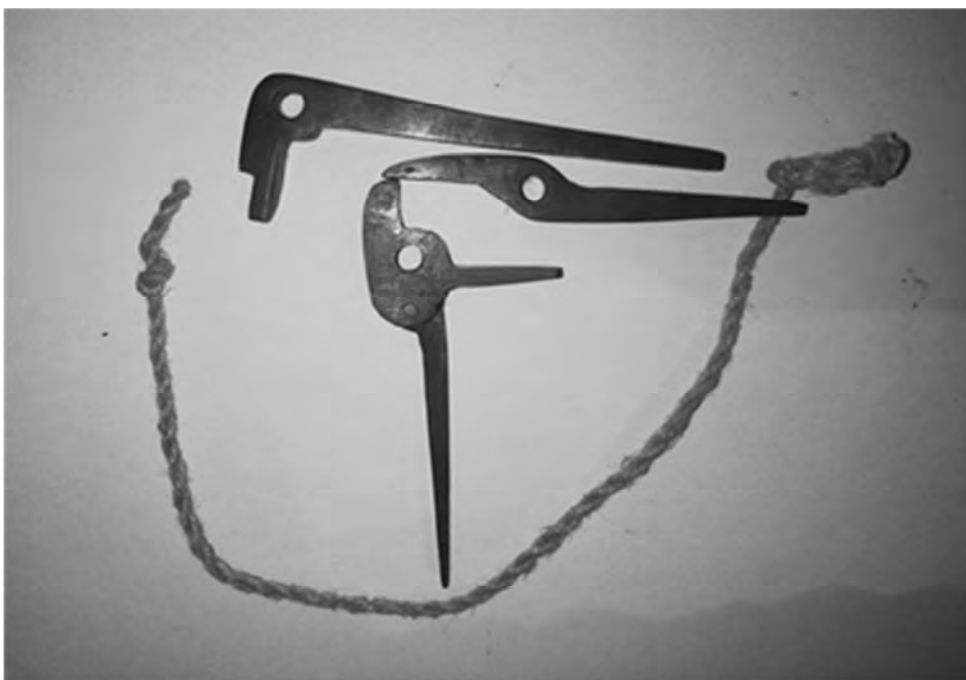
Podzespoły mechanizmu przyśpiesznika XVI w., rekonstrukcja
